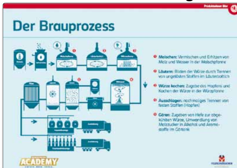
Übersicht des Brauprozesses in den Unterlagen der Feldschlösschen Academy.
